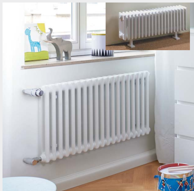
Zehnder Charleston , V 19 - 300 cm, L počet článků x 46 mm, H 62 - 210 mm (2-6 trubkové) Tip: V 600 mm, L 874 mm/19 čl., H 62 mm/2 tr., 861 W 2060-19-1270-9016-SMB, bílá, 9.897 Kč 2060-19-1270-0336-SMB, Volcanic, 12.961 Kč
